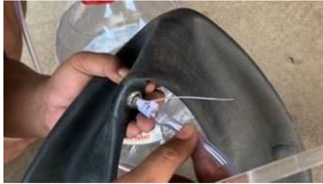
Gambar 3. Pemasangan selang ke ban dalam bekas
