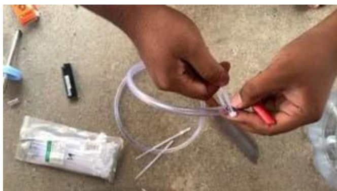
Gambar 2. Pemasangan selang ke kran bensin.
