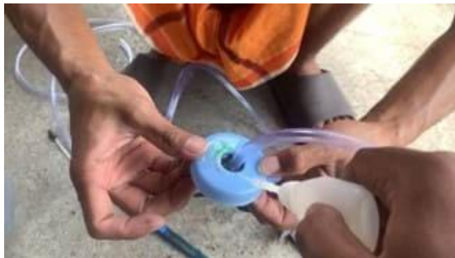
Gambar 1. Proses perekatan menggunakan lem dan debu
