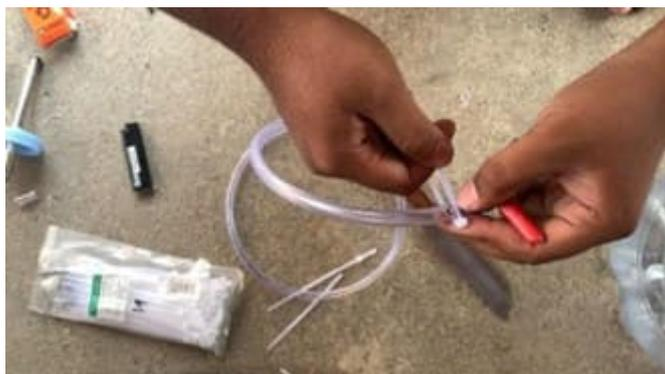
**Gambar 2.** Pemasangan selang ke kran bensin.
