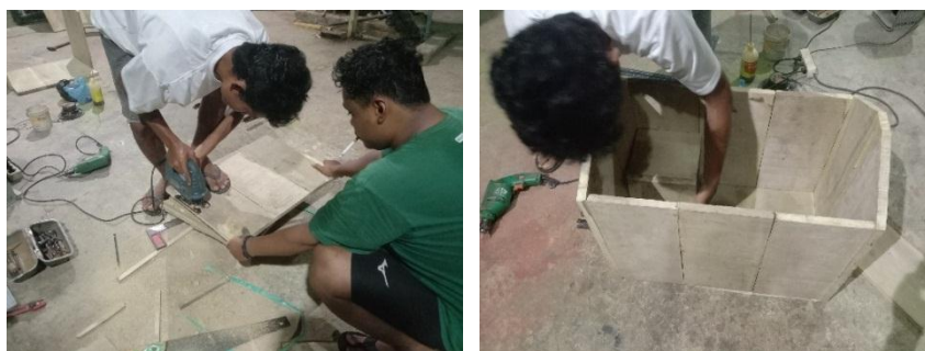
Gambar 3. Proses Penyusunan Papan Kayu menjadi Rubuha
