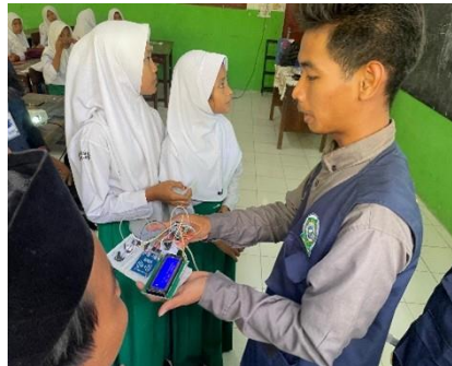
Gambar 3.2. Siswa mencoba melakukan absensi dengan menempelkan kartu RFID pada modul pembaca.
