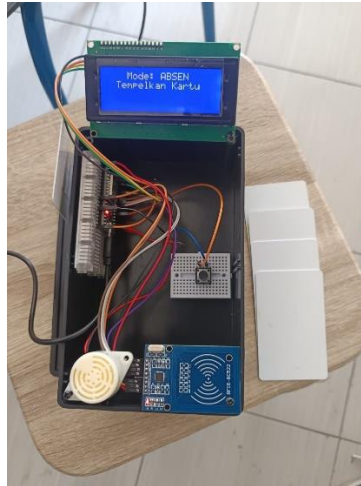
Gambar 3.1. Prototipe alat absensi digital berbasis RFID menggunakan ESP32, modul RC522, LCD 20x4 I2C, buzzer, dan push button.
