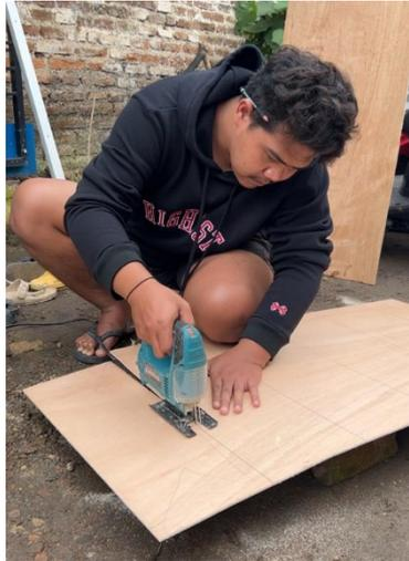
**Gambar 1.** Pemotongan Papan Tripleks Untuk Pembuatan Plakat
