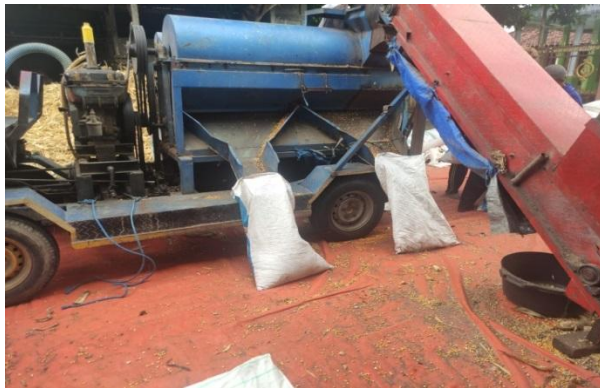
Gambar 2. Proses Pemisahan Klobot dan Bonggol Jagung dengan Mesin Selep
