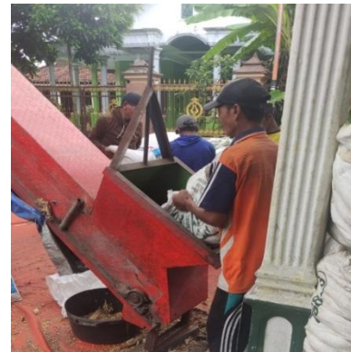
Gambar 2. Proses Pemisahan Klobot dan Bonggol Jagung dengan Mesin Selep
